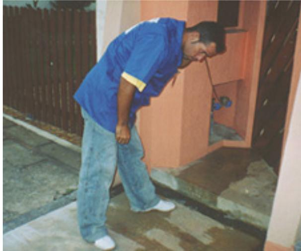
**Figura 2.3:** *Manuseio da haste de escuta metálica pelo operador[SR 10].*
